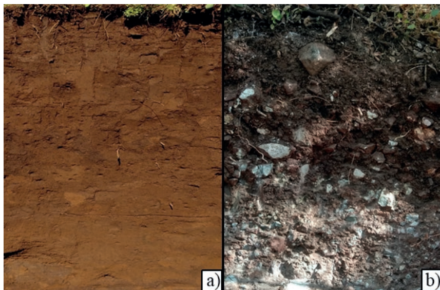
Figura 18. Perfiles de suelo con diferentes porcentajes de fragmentos gruesos: a) perfil sin fragmentos gruesos; b) perfil con porcentaje alto de fragmentos gruesos.
