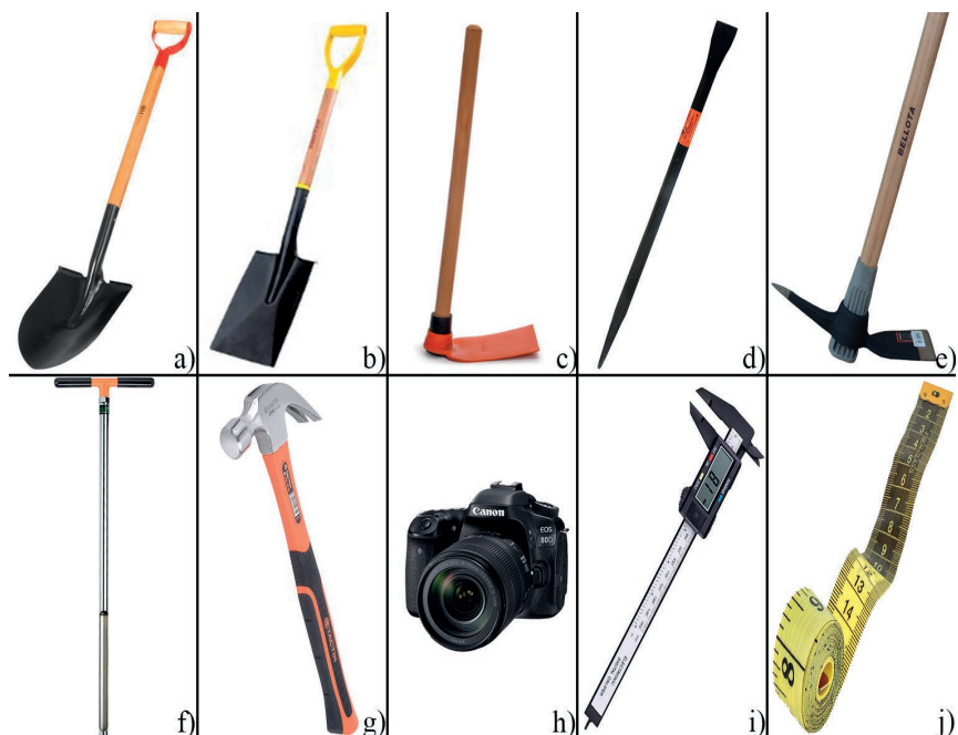
Figura 8. Equipo para muestreo de suelos: a) pala curva; b) pala plana; c) azadón; d) barra; e) pico; f) barreno; g) martillo; h) cámara fotográfica; i) vernier; j) cinta métrica.
