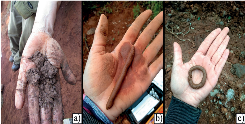
Figura 23. Ejemplos de algunas pruebas utilizadas para la estimación de textura del suelo en campo: a) muestra de suelo en la palma de la mano; b) formación de un cilindro con la muestra de suelo; c) formación de un aro con la muestra de suelo.
