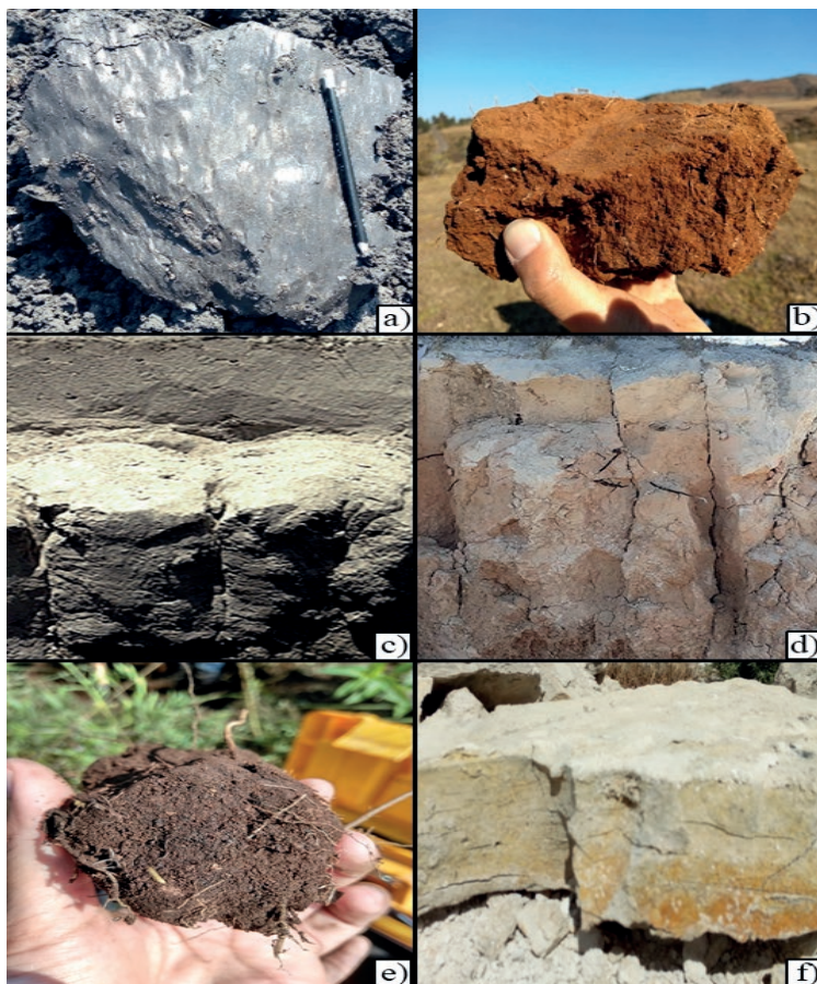
Figura 20. Ejemplos de diferentes tipos de estructura en los suelos: a) agregado tipo cuña con caras de deslizamiento; b) agregado tipo bloques subangulares; c) arriba, un horizonte masivo sin agregación y, abajo, agregados tipos columnas; d) agregado tipo columnar; e) agregado tipo migajón; f) agregado laminar con óxidos de hierro.
